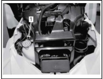
1. Reservatório de líquido de arrefecimento do motor
