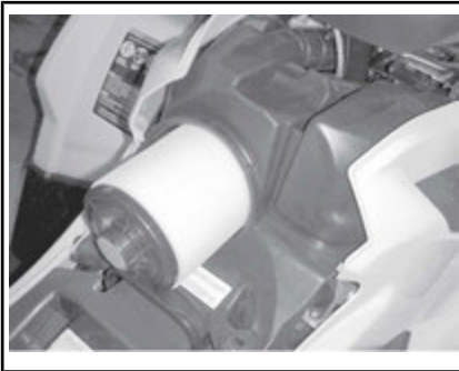
FJERNING AV LUFTFILTER
