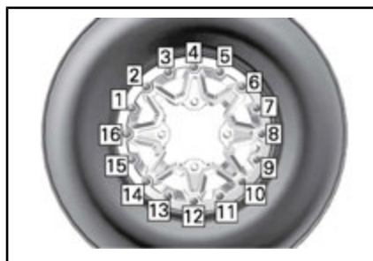
TYPEBILDE – TILTREKKINGSREKKEFØLGE SISTE TILTREKKING
