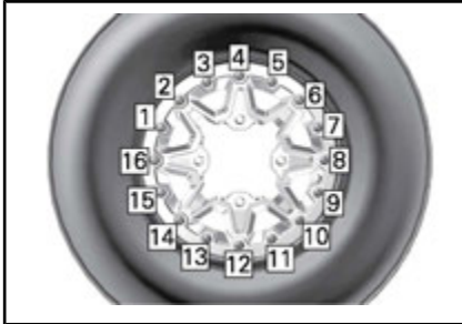
TYPIQUE - SÉQUENCE DE SERRAGE FINAL
