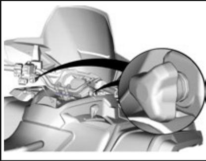
Para instalarlo, introduzca los brazos del parabrisas en sus soportes, y apriete las ruedecillas manualmente.
