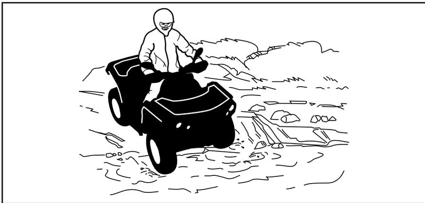
Si los frenos están húmedos, la capacidad de frenado del vehículo se ve afectada. Asegúrese de que se sequen los frenos; para ello, acciéndolos varias veces después de salir del agua, del barro o de la nieve con el vehículo. Tenga en cuenta la necesidad de una mayor distancia para el frenado.
