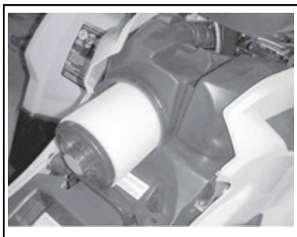
FJERNING AV LUFTFILTER
