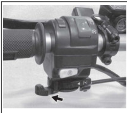
CHOKE I HELÖPPET LÄGE
