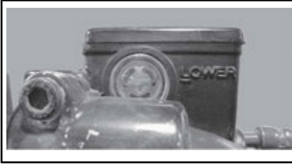
BAKRE BROMSVÄTSKEBEHÅLLARE PÅ VÄNSTER SIDA
