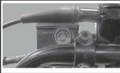
FRÄMRE BROMSVÄTSKEBEHÅLLARE PÅ HÖGER SIDA
