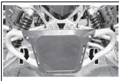
DS 90 X — PLACERING AV FRÄMRE FÄSTPUNKT
