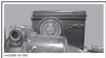
ЛЕВАЯ СТОРОНА — КОМПЕНСАЦИОННЫЙ БАЧОК ГИДРОПРИВОДА ЗАДНИХ ТОРМОЗОВ
