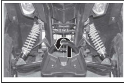
DS 70 EN DS 90: PLAATS VAN BEVESTIGINGSPUNT VOORAAN
