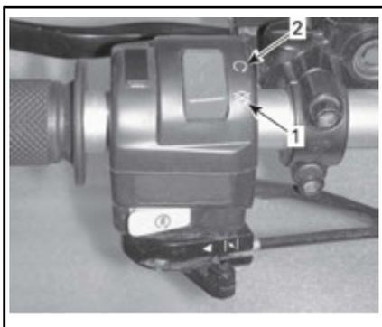
**CONFIGURAZIONE TIPICA - INTERRUTTORE DI EMERGENZA PER ARRESTO MOTORE**
