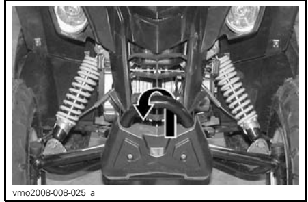
DS 70 AND DS 90 — FRONT TIE-DOWN POINT LOCATION
