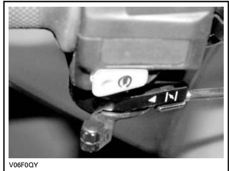
*CHOKE LEVER IN THE FULL CHOKE POSITION*
