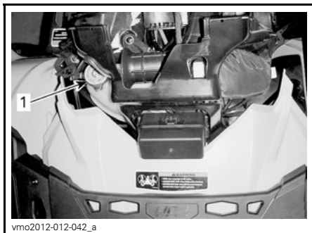
1. Beholder for motorkjølevæske
