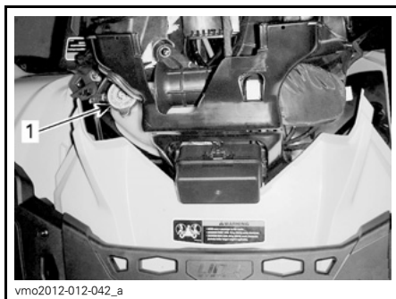
1. Løkk for motoroljebeholder
