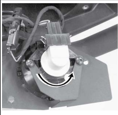
CONFIGURAZIONE TIPICA: RUOTARE LA LAMPADINA IN SENSO ANTIORARIO
