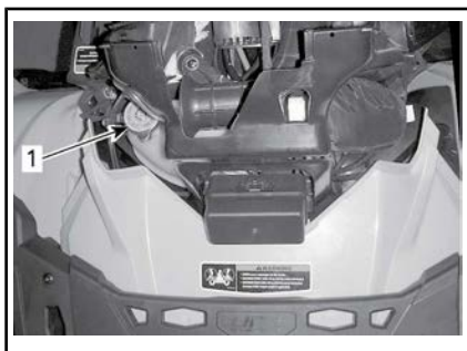
1. Serbatoio liquido refrigerante motore
