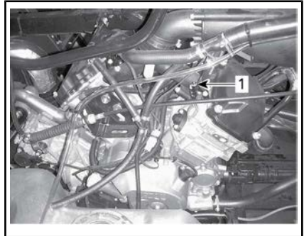
1. Tappo di scarico del liquido refrigerante
