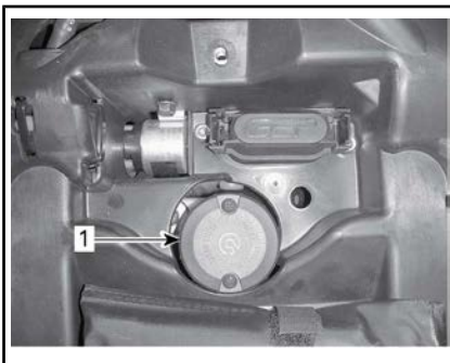
1. Serbatoio liquido dei freni posteriori
