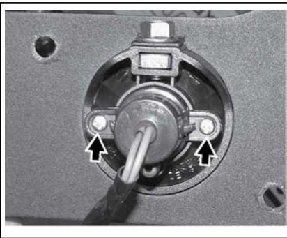
SVITARE LE VITI DI FISSAGGIO DALLA LAMPADINA DELLA FRECCIA POSTERIORE
