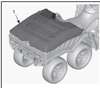
1. Hard top 1. Scollegare l'estremità superiore dell'ammortizzatore svitandola dall'hard top.
