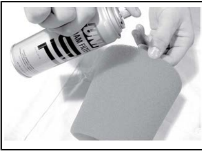
TÍPICO - LUBRIQUE EL FILTRO DE ESPUMA.
