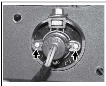
BEFESTIGUNGSSCHRAUBEN VON DER GLÜHLAMPE DES RÜCKWÄRTIGEN FAHRTRICHTUNGSANZEIGERS ABSCHRAUBEN
