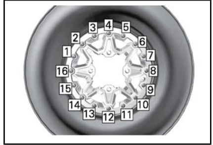
SITUAZIONE TIPICA - SEQUENZA DI SERRAGGIO FINALE
