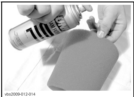
TYYPILLINEN - ÖLJYÄ VAAHTOMUOVISUODATIN
