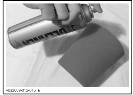
TYYPILLINEN - SUIHKUTA VAAHTOMUOVISUODATTIMEEN
