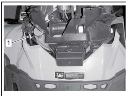
1. Depósito de refrigerante del motor
