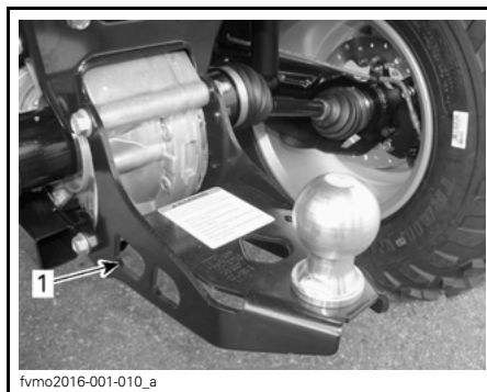
TYPBILD - PLACERING AV BAKRE FÄSTPUNKT
