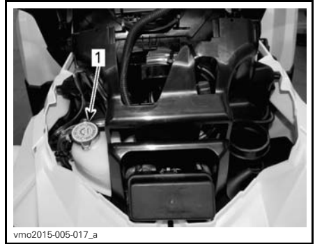
1. Réservoir de liquide de refroidissement
