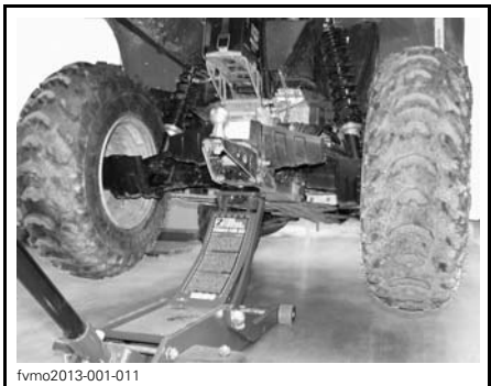
TYPIQUE — EMPLACEMENT DU POINT SUPÉRIEUR ARRIÈRE
