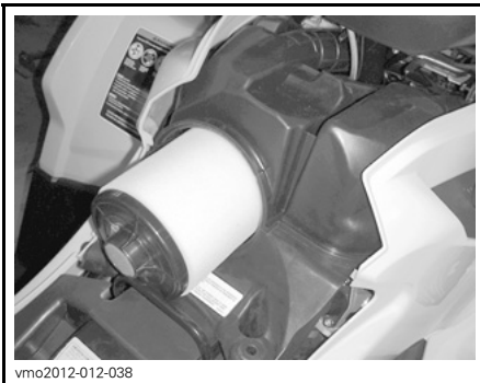
FJERNING AV LUFTFILTER
