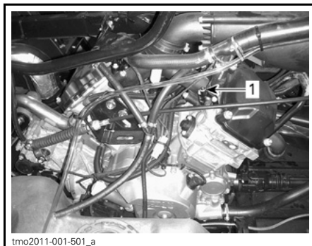
TYPEBILDE 1. Lufteskruer for fremre sylinder
