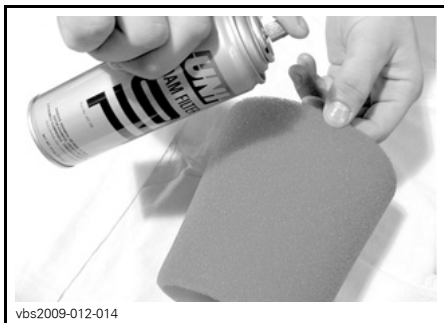
TYPEBILDE – OLJE PÅ SKUMFILTERELEMEN
