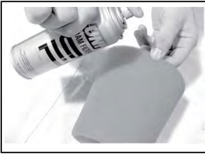
TYPISCH - FILTERELEMENT MET OLIE SMEREN
