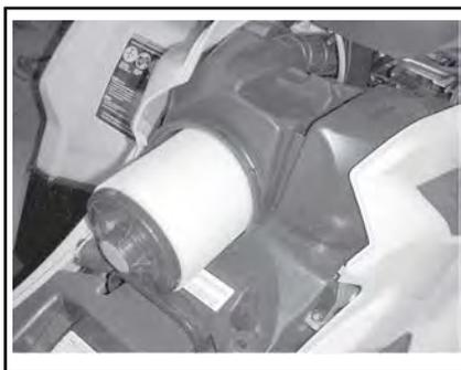
**RIMOZIONE DEL FILTRO DELL'ARIA**
