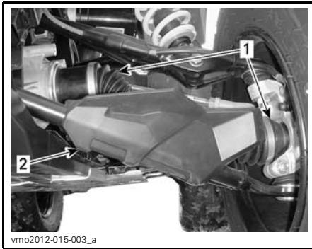
TYPIQUE — AVANT DU VÉHICULE 1. Soufflets d'arbre d'entraînement 2. Protecteur d'arbre d'entraînement
