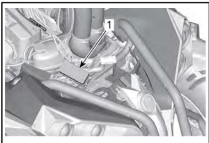
1. Vorderer Sicherungskasten
