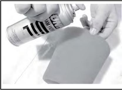
*TYPISCH - SCHAUMFILTERELEMENT ÖLEN*
