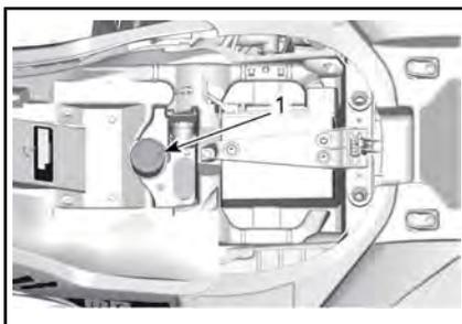
1. Behälter für Bremsflüssigkeit der hinteren Bremse
