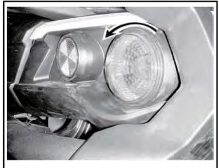
*RÜCKLEUCHE ZUM ENTFERNEN GEGEN DEN UHRZEIGERSINN DREHEN*
