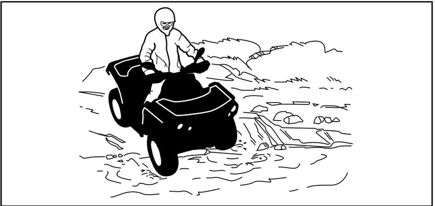
Wasser beeinträchtigt die Bremsleistung Ihres Fahrzeugs. Sorgen Sie durch mehrfaches Betätigen dafür, dass Ihre Bremsen wieder trocken werden, nachdem das Fahrzeug das Wasser verlassen hat.
