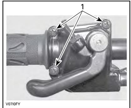
1. Diese Schrauben entfernen
