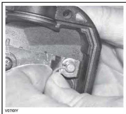
Entfernen Sie die Seitenabdeckung der Drosselklappe.
