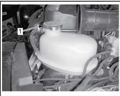
1. Tampa do reservatório do líquido de arrefecimento do motor
