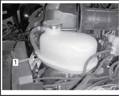
1. Reservatório do líquido de arrefecimento do motor
