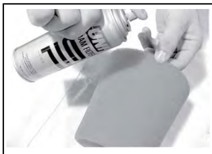
TYPISCH - SCHAUMSTOFFFILTER ÖLEN
