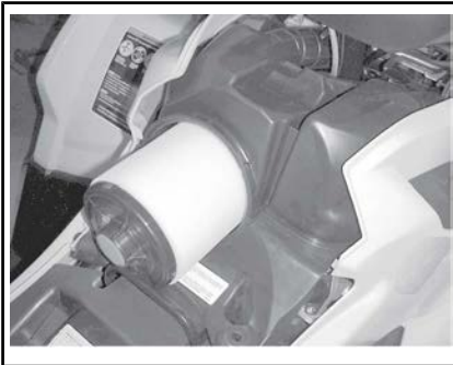
REMOÇÃO DO FILTRO DE AR
