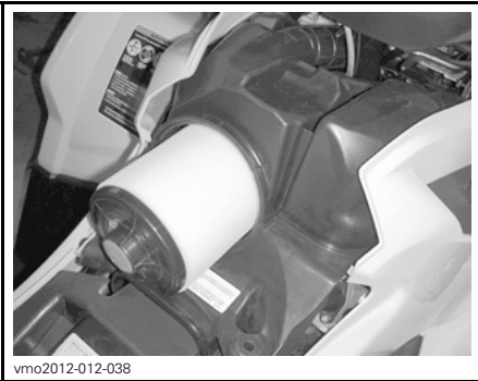
FJERNING AV LUFTFILTER
