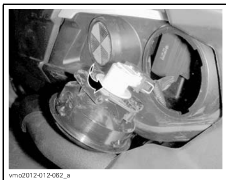
FAIRE TOURNER L'AMPOULE DANS LE SENS ANTIHORAIRE
