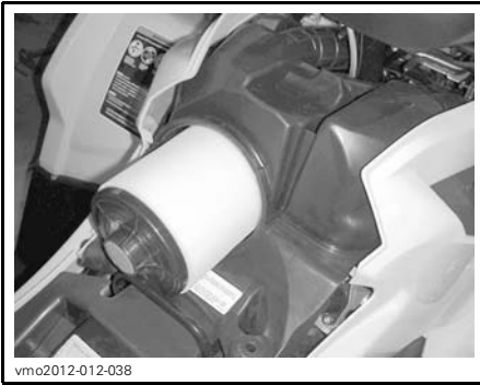
DÉPOSE DU FILTRE À AIR
