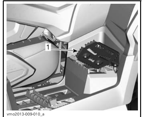
TYPIQUE 1. Repose-pied pour conduite dans la boue
