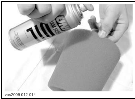
TYPIQUE - HUILER L'ÉLÉMENT DU FILTRE EN MOUSSE
