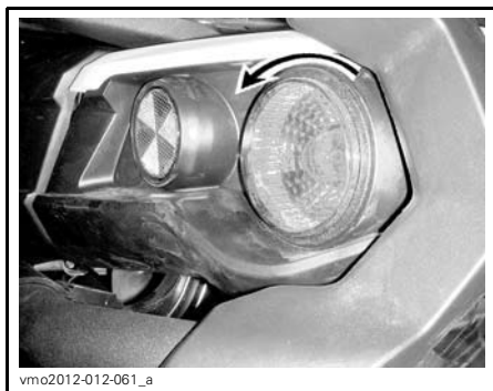
FAIRE TOURNER L'AMPOULE DANS LE SENS ANTIHORAIRE POUR L'ENLEVER
