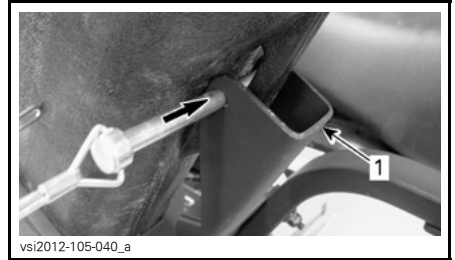
1. Den bøyde platen til våpenholderstøtten
