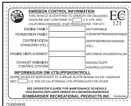
TYPEBILDE – PLASSERING: UNDER SETET PÅ ØVRE RAMMEDEL
