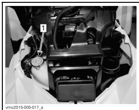
1. Beholder for motorkjølevæske
