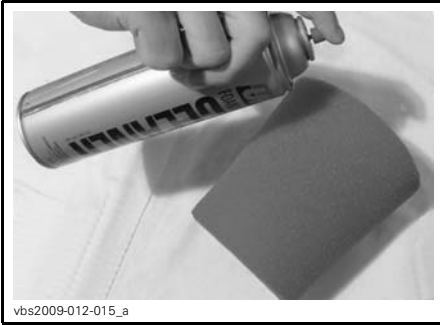
TYPIQUE - VAPORISATION SUR LE FILTRE EN MOUSSE
