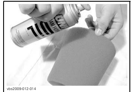
TYPIQUE - LUBRIFICATION DU FILTRE EN MOUSSE
