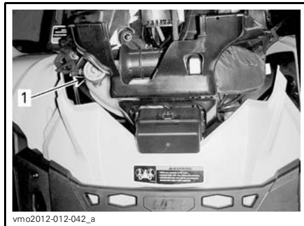
1. Réservoir de liquide de refroidissement
