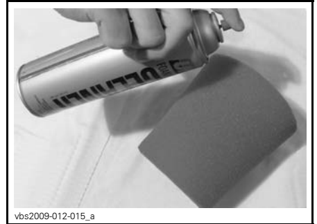
TYYPILLINEN - SUIHKUTA VAAHTOMUOVISUODATTIMEEN
