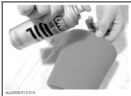
TYYPILLINEN - ÖLJYÄ VAAHTOMUOVISUODATTIMIN
