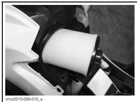
FJERNING AV LUFTFILTER
