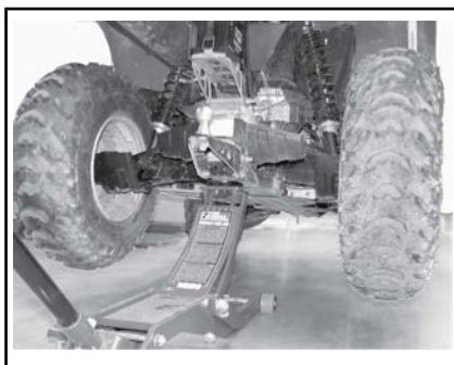
INSTALLATION TYPIQUE — EMPLACEMENT DU POINT ARRIÈRE HAUT
