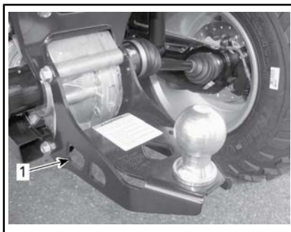
EMPLACEMENT DU POINT D'ARRIMAGE ARRIÈRE TYPIQUE
