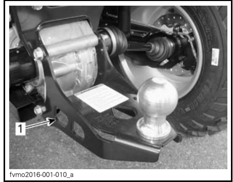
TYYPILLINEN - KIINNITYSKOHTA TAKANA
