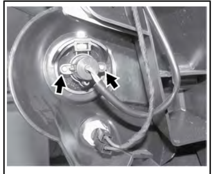
DRAAI DE BEVESTIGINGSSCHROEVEN VAN DE VOORSTE RICHTINGAANWIJZER-LAMP LOS
