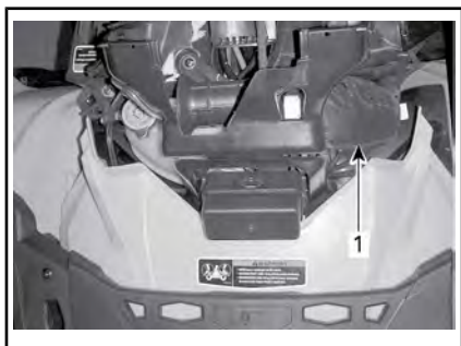
1. Filtro de aire de la CVT
