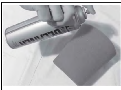
TÍPICO - ROCÍE EL FILTRO DE ESPUMA.
