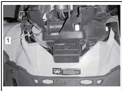
1. Depósito de refrigerante del motor
