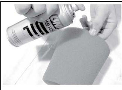
TYPISCH - FILTERELEMENT MET OLIE SMEREN
