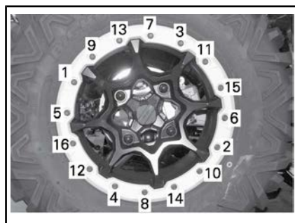
SITUAZIONE TIPICA - SEQUENZA DI SERRAGGIO
