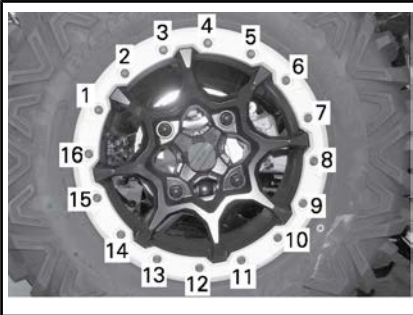
SITUAZIONE TIPICA - SEQUENZA DI SERRAGGIO FINALE
