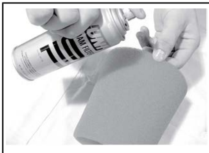
CONFIGURAZIONE TIPICA - LUBRIFICARE L'ELEMENTO FILTRANTE IN MATERIALE ESPANSO
