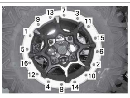
SITUAZIONE TIPICA - SEQUENZA DI SERRAGGIO
