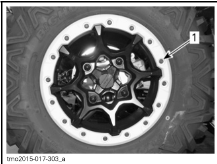
1. Beadlock on kiristettävä käsin
