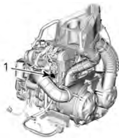
TYPISCH — HINWEISSCHILD MIT MOTORSERIENNUMMER
