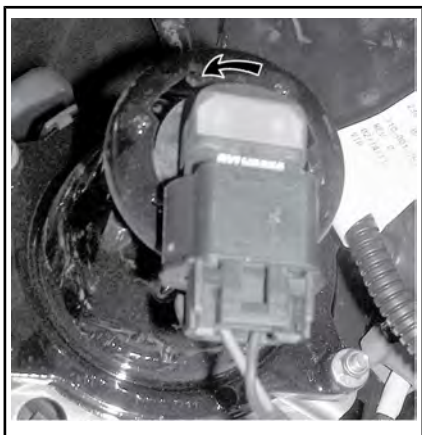
RUOTARE LA LAMPADINA IN SENSO ANTIORARIO
