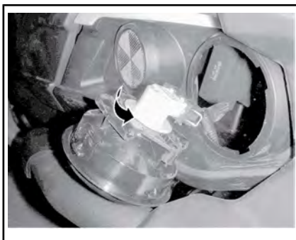
RUOTARE LA LAMPADINA IN SENSO ANTIORARIO
