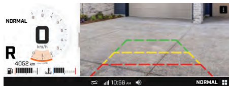
1. Omtrentlig synsfelt for bakre kamera
