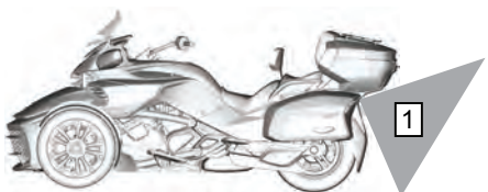
1. Omtrentlig synsfelt for bakre kamera
