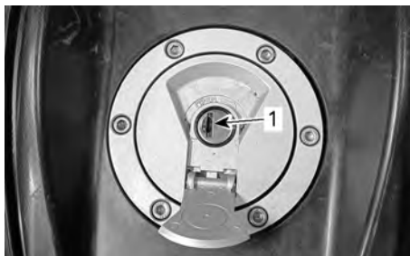
1. Incavo per la chiave del tappo del serbatoio
