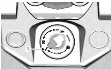
1. Position d'ouverture du siège du passager
