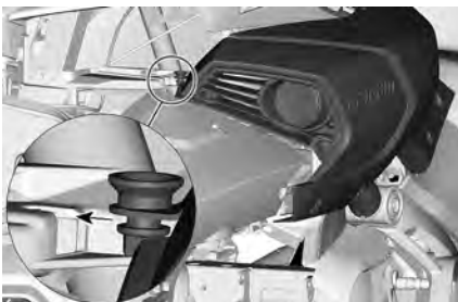
TYPISCH – VERKLEIDUNGEN ORD- NUNGSGEMÄß AUSRICHTEN
