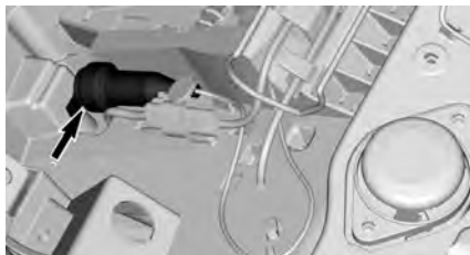
DC56 – HINTERER ZUBEHÖRSCHALT-KREIS DES KUNDEN – UNTER DEM BEIFAHRERSITZ
