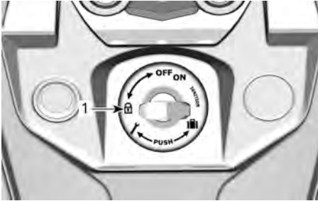
1. Position zum Verriegeln des Lenkers und Handschuhfachs
