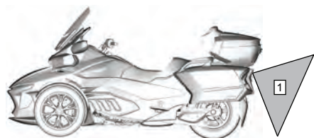
1. Cône de vision approximatif de la caméra arrière
